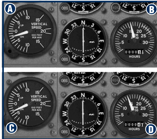
Abbildung 6-4. A - Variometer und B - Drehzahlmesser bei leicht erhöhter Leistung. C - Variometer und D - Drehzahlmesser bei leicht verringerter Leistung.
