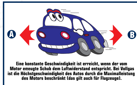
Abbildung 1-2. Bei einem Auto wird A - Schub durch die Motorleistung erzeugt und der B - Luftwiderstand durch den Widerstand der Luftmoleküle verursacht.
