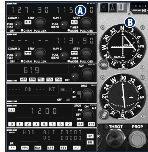
Abbildung 12-1 A - VOR-Empfänger, B - VOR-Anzeige.
